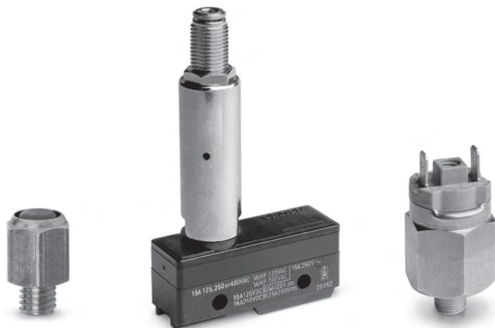
Реле давления с диафрагмой Серия РМ поставляются двух моделей: с Н.З. (нормально закрытые) и Н.О. (нормально открытые) контактами. Требуемое значение давления устанавливается регулировочным винтом с помощью небольшой отвертки. Реле давления, в частности, используются как устройства безопасности.
