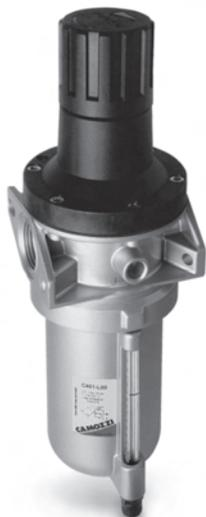
Фильтры-регуляторы Серии С поставляются с присоединительным размером G1. Фильтры-регуляторы широко используются для подготовки воздуха в современных пневмосистемах благодаря совмещению функций фильтра и регулятора давления в одном устройстве с меньшими габаритными размерами и меньшей стоимостью, чем два устройства отдельно.
