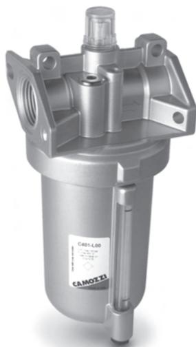
Маслораспылители Серии С поставляются с присоединением G1. Алюминиевый стакан с байонетным креплением имеет прозрачную мерную трубку. Расход масла можно регулировать винтом в верхней части корпуса маслораспылителя и контролировать по частоте падения капель внутри прозрачного колпачка.
