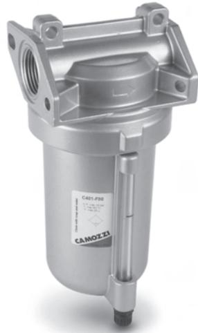
Коалесцентный фильтр **Серии С** поставляется с присоединением **G1**. **Алюминиевый стакан с байонетным креплением** имеет прозрачную мерную трубку для индикации уровня конденсата (максимальный уровень отмечен красной чертой). Коалесцентный фильтр **Серии С** может быть оснащен механизмом слива конденсата двух типов - ручным/полуавтоматическим или автоматическим.
