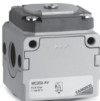
Клапан “мягкого” пуска позволяет избежать поломок оборудования и травмирования персонала при включении пневматической системы с цилиндрами. Клапан “мягкого” пуска делает возможным постепенно увеличивать давление в пневматической системе до 50% от входного значения, после чего величина давления скачком увеличивается до магистрального (100%). Обычно клапан “мягкого” пуска устанавливается после блока подготовки воздуха.
