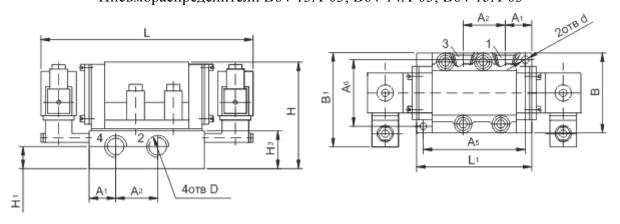
Пример записи при заказе распределителя четырехлинейного с электропневматическим односторонним управлением и пружинным возвратом, условным проходом 16мм с резьбовым присоединением пневмолиний, климатического исполнения УХЛ, категории размещения 4:
