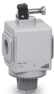
EV11 = клапан безопасности с электро-пневматическим управлением, 3/2 лин./поз., моностабильный, внешняя запитка пилотов, двустороннее ручное дублирование
