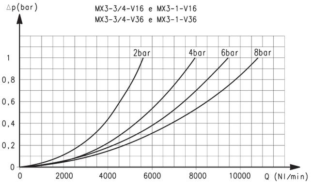
Диаграммы для клапанов с электропневматическим или пневматическим управлением MX3
