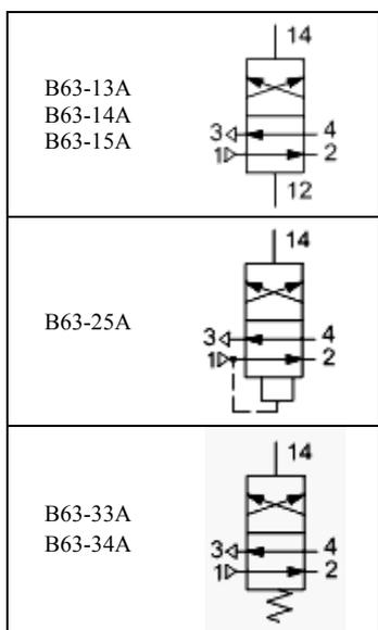
**СТРУКТУРНАЯ СХЕМА ОБОЗНАЧЕНИЯ**
