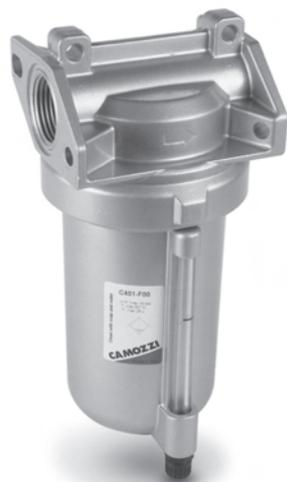
Фильтры Серия С поставляются с присоединительным размером G1. Алюминиевый стакан с байонетным креплением имеет прозрачную мерную трубку для индикации уровня конденсата (максимальный уровень отмечен красной чертой). Фильтры Серия С оснащены полуавтоматическим/ручным клапаном слива (реагирует на падение давления на входе ниже 0,3 бара или при отключении компрессора в конце смены) или автоматическим клапаном с поплавком.
