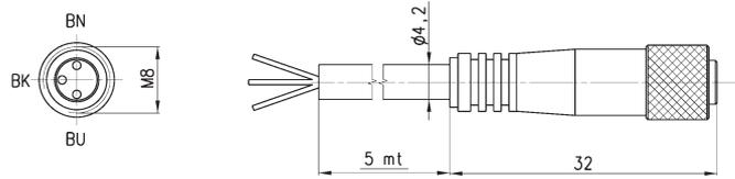
В случае, использования 2-х проводного датчика с разъемом M8 (CST-250N, CSV-250N и CSH-253), соедините коричневый провод с "+" источника питания и черный провод с нагрузкой.
