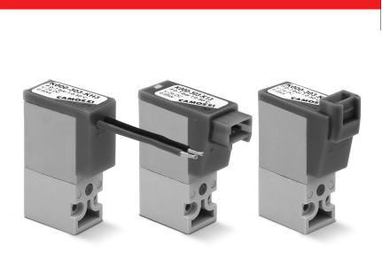
Электропневматические распредилители прямого действия Серии К могут работать на воздухе как с распыленным маслом, так и без масла. Они поставляются 3/2 лин./поз. нормально закрытые или нормально открытые. Монтажные плиты могут быть как одноместными, так и многоместными. На эти плиты можно монтировать и Н.З. и Н.О. клапаны (но для последних нужен специальный переходник).
