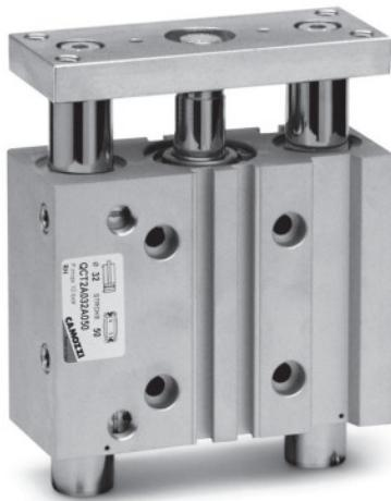
Обе модели оборудованы демпфированием в конце хода для предотвращения ударов поршня о крышки. Дизайн корпуса цилиндра позволяет его монтировать за любую поверхность. В Т-образные пазы возможно устанавливать магнитные датчики в различных положениях.
