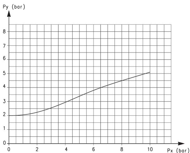
Диаграмма показывает зависимость между рабочим давлением и давлением, необходимым для того, чтобы привести в действие клапан. Давление открытия одностороннего клапана 0,3 бар.
