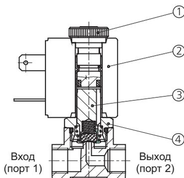
1. Гайка фиксации катушки
