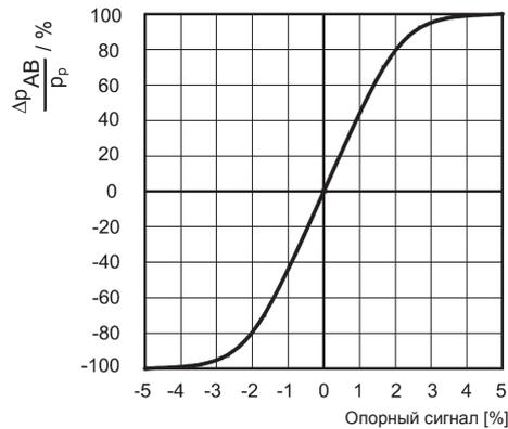
Показан коэффициент усиления давления в % отношения между изменением давления на отверстиях А или В ( $\Delta P_{AB}$ ) и давлением в системе Р в зависимости от опорного сигнала. На практике усиление давления характеризует реакцию клапана на устранение внешних возмущений и стабилизацию положения исполнительного механизма.
