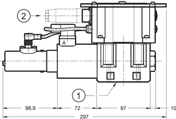
Настроечный винт установленный на заводе .
