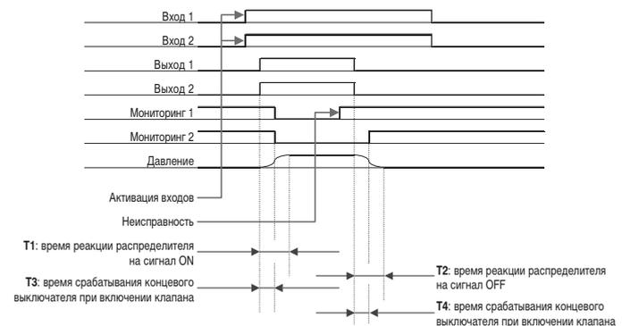
\* Контакты следящего устройства нормально замкнуты. Т.е. когда катушка распределителя не запитана, контакты замкнуты и сигнал мониторинга активен.
