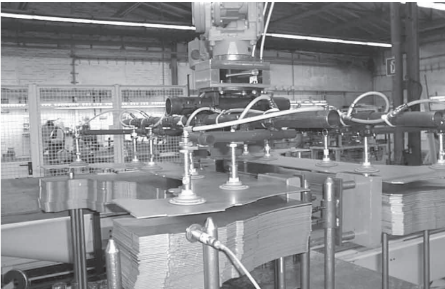
Пружинные плунжеры FSTE используются в вакуумной системе типа «паук» для манипулирования листами металла в автомобильной промышленности
