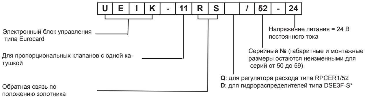
UEIK-11RS\*/52 представляет собой блок типа Eurocard для управления в режиме с обратной связью по положению золотника электромагнитными пропорциональными клапанами с одной катушкой.
