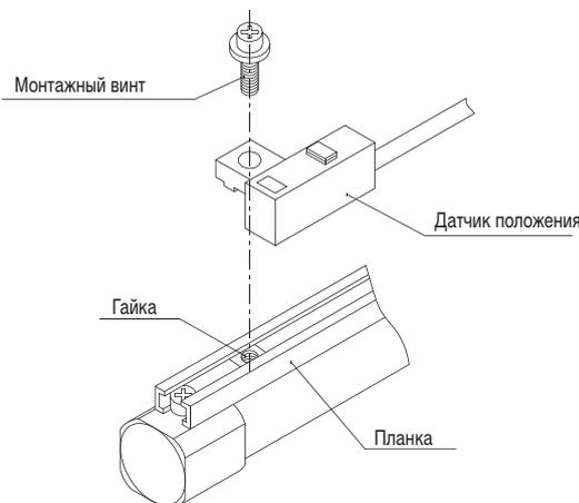
1. Установите гайку на монтажной планке в месте, где должен быть смонтирован переключатель.
