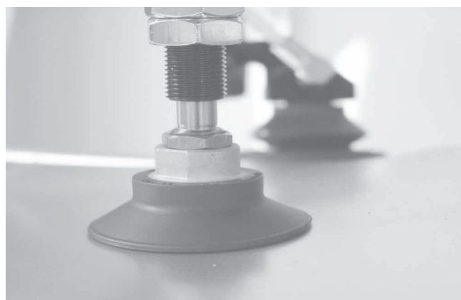
Вакуумная система типа «паук» с плоскими вакуумными присосками SAF для подъема готовых частей изготовленных прессованием
