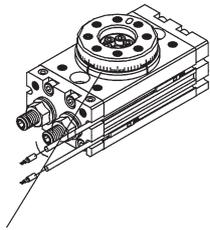
Цилиндрическая поверхность может быть использована для центрирования
