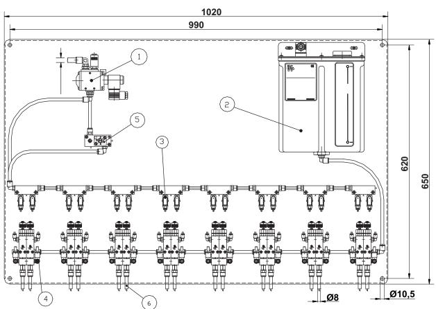
Система предназначена для смазки ленты шириной от 50мм до 800мм.
