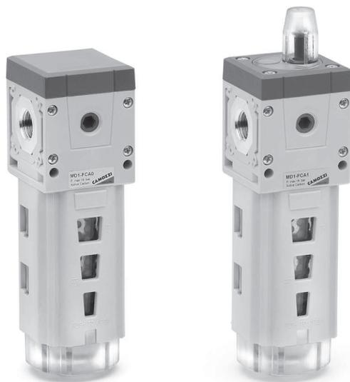
В блоке фильтров фильтр с активированным углем устанавливается четвертым, после двух центробежных 25 мкм и 5 мкм и коалесцентного, поскольку он требует предварительной фильтрации как и коалесцентный. Учитывая характеристики данного фильтра, рекомендуется заменять фильтрующие элементы каждые 6 месяцев или после 1000 рабочих часов.
