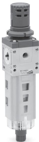
Фильтр-регулятор содержит и фильтр, и регулятор давления серии MD. Уменьшенный размер и вес также делают их пригодными для применения в мобильных устройствах. Обратный клапан позволяет быстро сбросить избыток давления. Разные типы пружин позволяют получить более точную регулировку давления в зависимости от выбранного диапазона регулирования.
