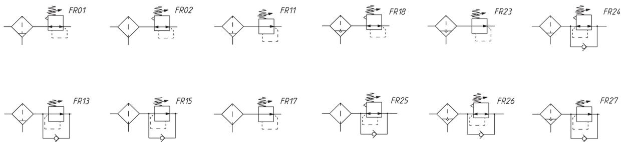
FR01 = фильтр-регулятор со сбросом давления, с ручным сбросом конденсата
