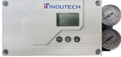
Электропневматический смарт-позиционер EPSP350 контролирует положение запорного органа арматуры в соответствии с входящим сигналом 4...20 мА от различных устройств управления.
